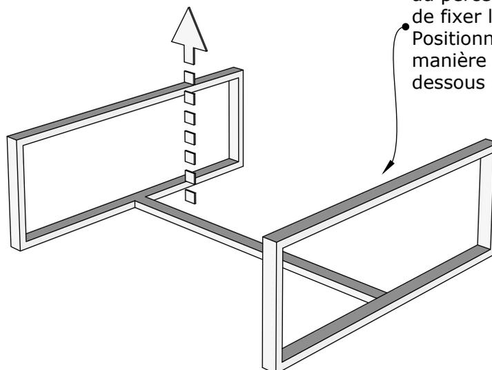
Utiliser des vis #10, adaptées au perçage métallique afin de fixer le pied de la boîte.
